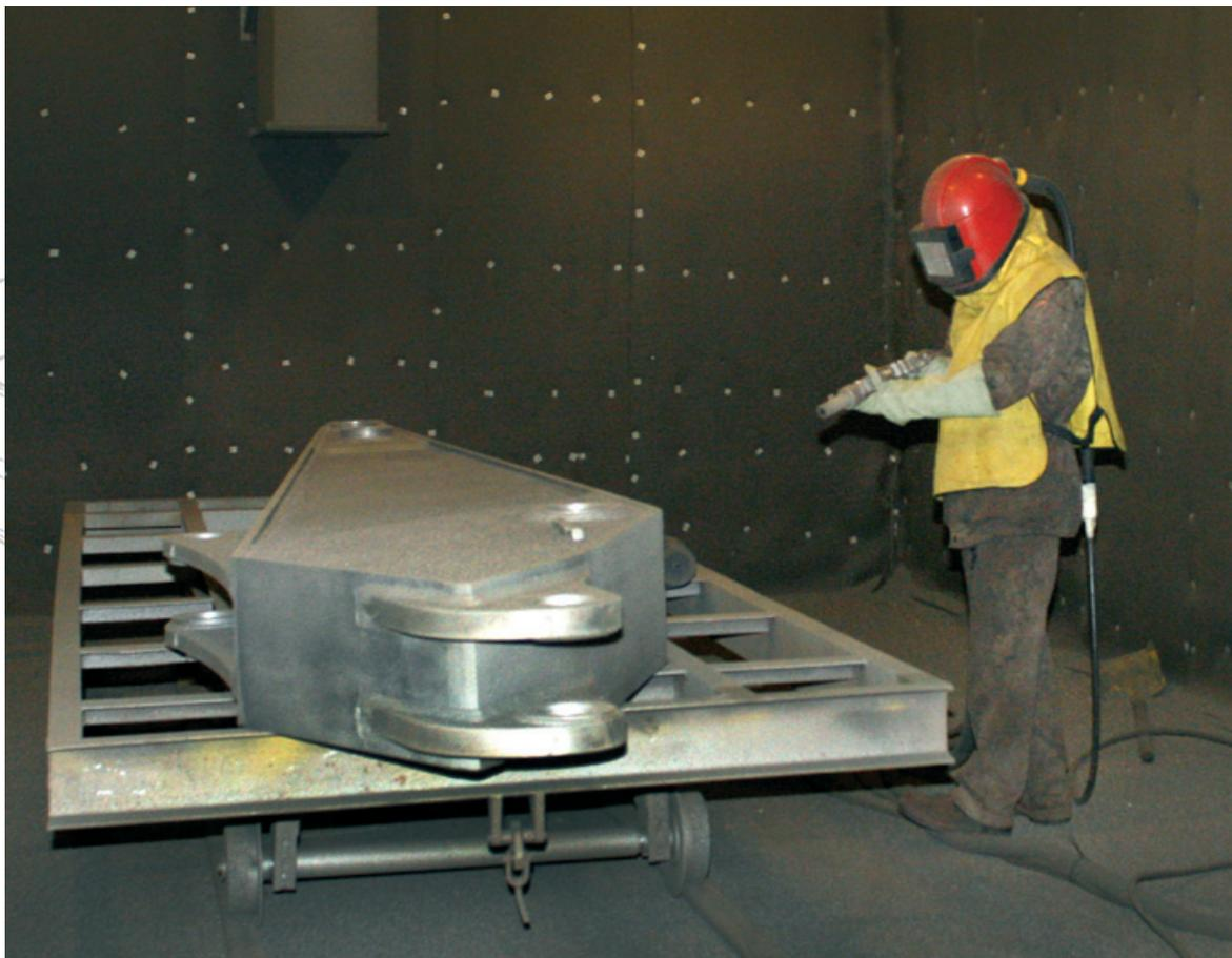
Компания «Профессионал» оказывает услуги по дробеструйной очистке габаритных деталей и подготовке поверхности к покраске, напылению, шпаклевке, облицовке, склеиванию и сварке. Дробеструйную очистку применяют при очистке металла от старого лакокрасочного покрытия и ржавчины.
